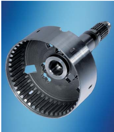
Bild 2: Außenlamellenträger für die Verteilerkupplung allradgetriebener Fahrzeuge mit reduziertem Zerspanungsaufwand. Das Basisbauteil wird zunächst durch eine Halbwarmumformung hergestellt. Die Verzahnungen entstehen in einem anschließenden Kaltumformprozess. Bild: Hirschvogel
