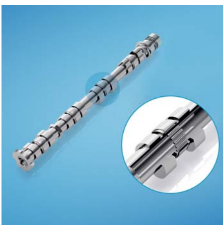
Bild 4: Gewichtsparende gebaute Nockenwelle aus einem Rohr mit aufgepressten, geschmiedeten Nocken und integrierten einteiligen Wälzlagern. Dadurch um 20 Prozent verringerte Reibungsverluste speziell bei niedrigen Drehzahlen (Start-Stopp-Betrieb von Hybridantrieben). Bild: Neumayer Tekfor
